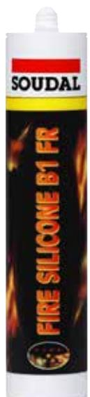
**Firesilicone B1 FR** yüksek kaliteli, nötr, elastik, tek komponentli, yanın geciktirme standartı DIN 4102 B1 ile uyumlu ve bazı tür derzlerde 4 saat boyunca yanına dayanabilen (EN 1366 Bölüm 4NN713.020-BS 476/20), silikon bazlı nötral karakterde izolasyon malzemesidir.
